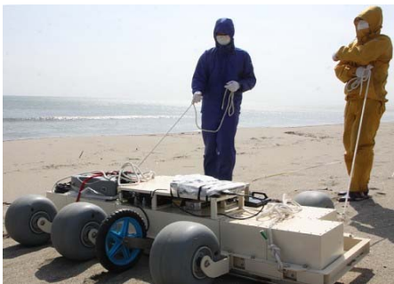
アレイ型GPRによる 津波被災者捜索活動
