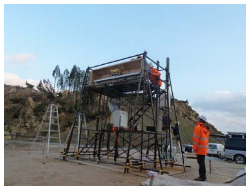
地表設置型合成開口レーダ(GB-SAR)を利用した地滑りモニタリング(宮城県栗原市)
