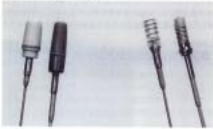
図 2-31 携帯用アンテナの形状と接続状態
