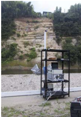
東北大学が開発したGB-SAR装置を用いて計測した広瀬川河岸のレーダー画像
