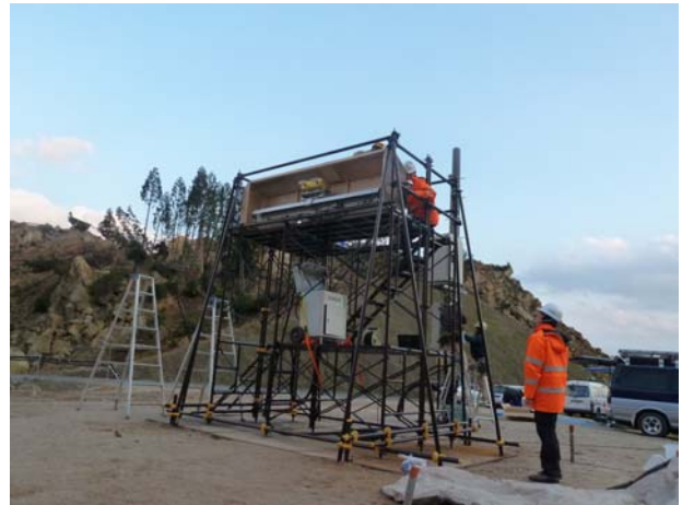
荒砥沢に設置されたGB-SAR装置
