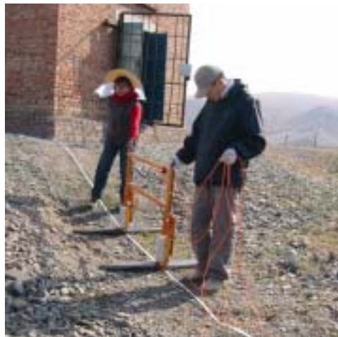
図1 地中レーダ装置と計測の様子 Fig.1 GPR apparatus and survey
