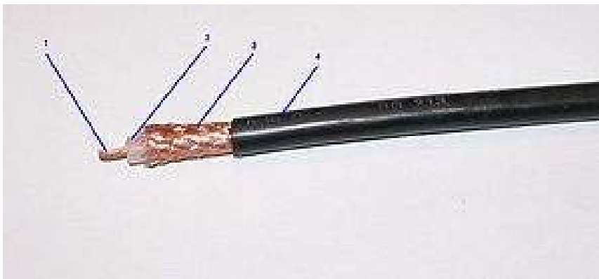
同軸ケーブル (ケーブルTV, 高周波計測)
