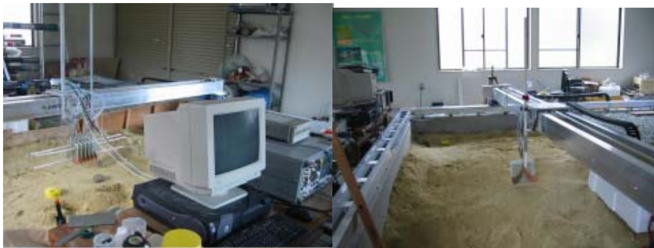
図4 地中レーダテスト中の SAR-GPR アンテナ
