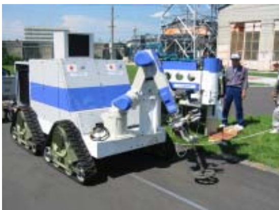
図2 SAR-GPR を搭載する小型車両
