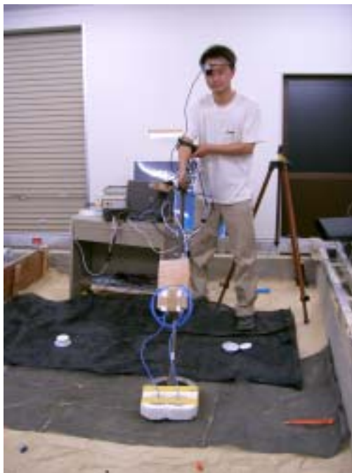
図 9 ハンドヘルド型地雷検知装置（金属探知機と GPR の複合センサ）
